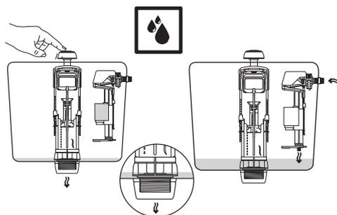
El flotador Azor Plus con su sistema retardador, sólo empieza a trabajar después del cierre del descargador. Así se obtiene un ahorro de 0,5 litros en cada descarga, lo que resulta un ahorro diario de 9 litros.
