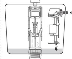
Una vez que se descarga el agua, la válvula de descarga se cierra y el sistema retardador hace que el flotador de entrada se abra para llenar el tanque.
