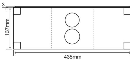
El soporte y la placa de inspección tienen las dimensiones necesarias para colocar la placa de control y los dos azulejos portugueses en las extremidades, asegurando así el acceso al interior de la cisterna para llevar a cabo las posibles acciones de mantenimiento.
