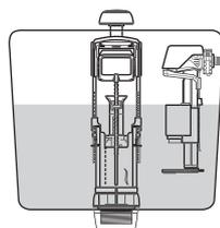
MODO DE FUNCIONAMIENTO DESCARGA COMPLETA
