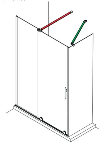
Mampara angular (pag 66) compuesto por un frontal, con tensor angular, con lateral fijo y kit magnético angular.
