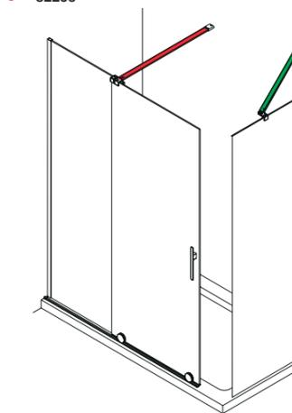
Mampara angular (pag 66) compuesto por un frontal, con tensor angular y con lateral fijo.
