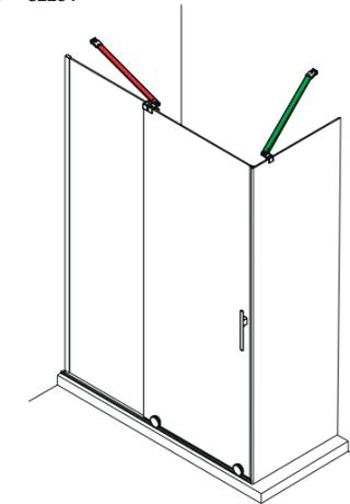
Mampara angular (pag 66) compuesto por un frontal, con tensor frontal y con lateral fijo.
