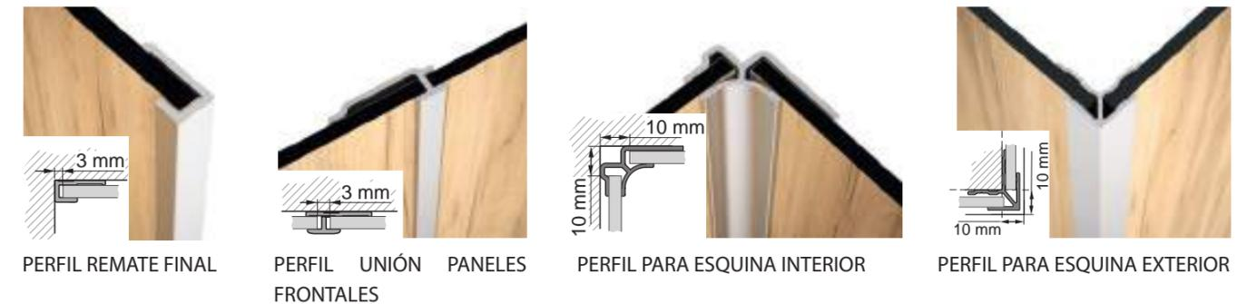
Los paneles de 4mm se pueden montar directamente unión a unión, o con el conjunto de perfiles de aluminio anodizado brillo que hemos diseñado para unión entre paneles, esquinas y remates que facilitan la instalación y permite corregir las típicas desviaciones de las paredes de los que te recomendamos su uso ya que además conseguirás un FINITION realmente estético.
