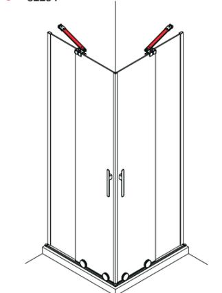
Mampara angular (pag 68) compuesto por 2 frontal, con tensor angular y kit magnético angular.
