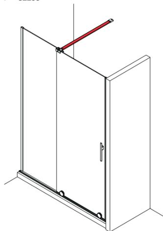
Mampara frontal (pag 64) compuesto por tensor angular y kit magnético frontal
