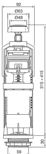
Adaptadores incluidos. Compatibles con cerámica Roca permitiendo sustitución de la válvula sin sacar el autoclave de cerámica
